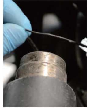
⑤ 伸縮チューブにヒートガン等で熱を加え密着させ保護します。
