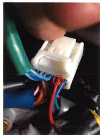
④ コネクタに付属配線の 電源部 4P ハーネス (赤) を ○2 番へ挿入し、 クリップの嵌合を戻し、 コネクタを元の位置に戻します。
