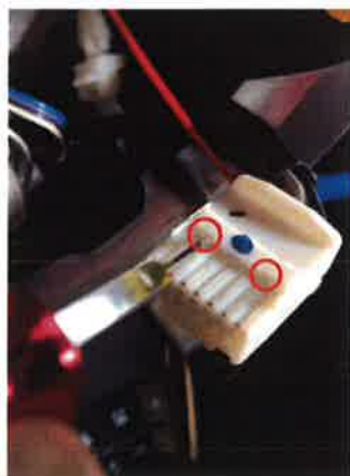
② コネクタの○クリップ嵌合を 図等で持ち上げ外します。
