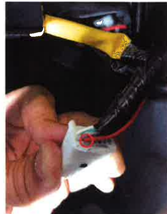
④ コネクタに付属配線の 電源部ハーネス (赤) を ○13 番へ挿入し、 クリップの嵌合を戻し、 コネクタを元の位置に戻します。
